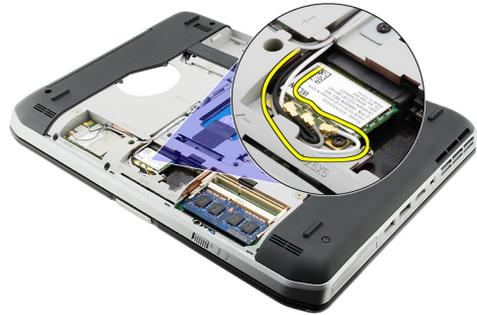
5. قم بإزالة المسمار المثبت لبطاقة WLAN في لوحة النظام.
